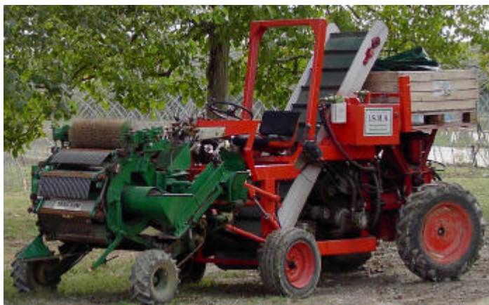
Fig. 9 - Macchina completa: testata e mezzo semovente.
