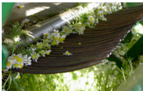
Fig. 8 – Pettine orizzontale che effettua lo strappo verticalmente
