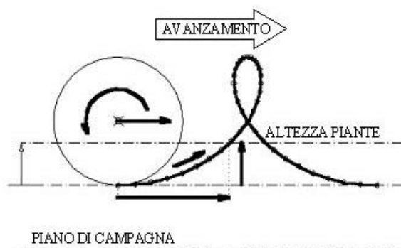
Fig. 1 – Rappresentazione grafica del cilindro a pettinamento frontale.
